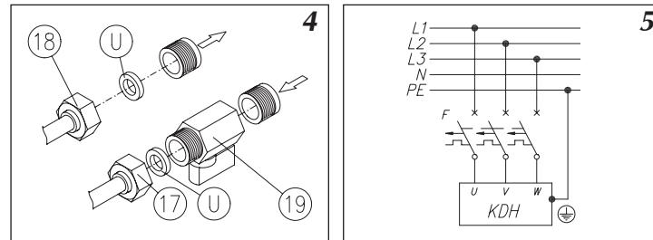
**Рис.5 Электрическое подключение**
